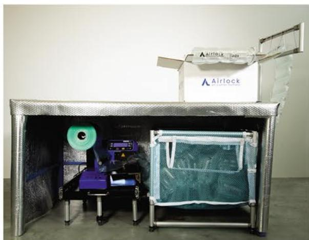
Utilissimo per ambienti con poco spazio. Si può utilizzare con bobine di altezza 20cm e 40 cm. (Richiede solo corrente 220V)
